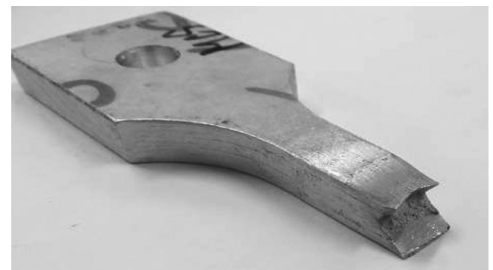
(b) 2219C10S位于焊缝前进侧的接头断裂方式
