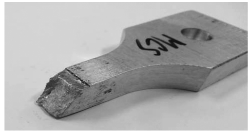
(a) 2219MCS位于焊缝前进侧的接头断裂方式
