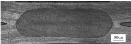
图 2 点焊焊核的金相图
