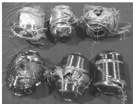
图3 PBO纤维与T700碳纤维混杂复合材料Φ150 mm容器水压爆破试验前后的状态
