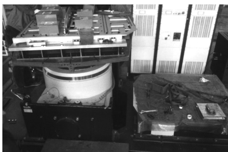
图6 试验样机安装方式
