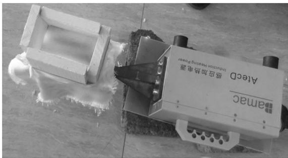
图 1 感应加热试验结构示意图
