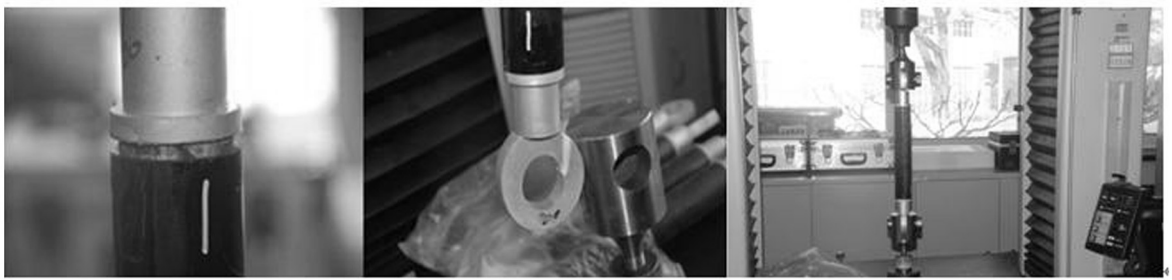
(b) 金属件销孔处拉断
