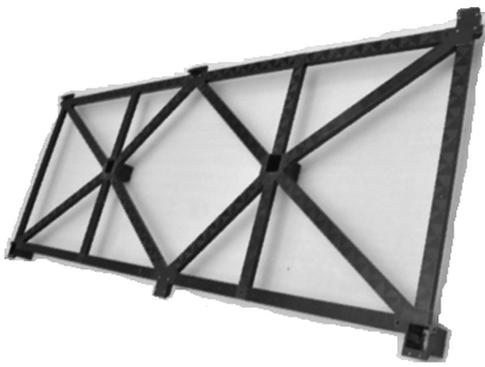
图 15 某型号太阳翼压紧框架
