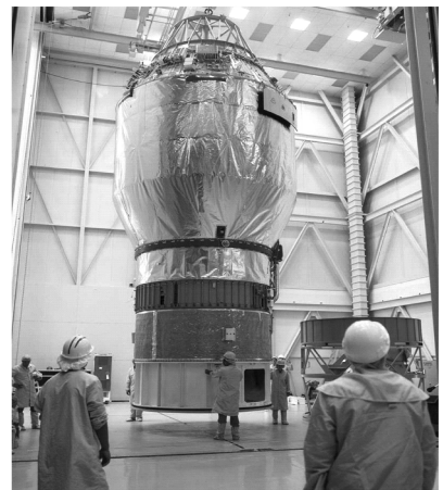
图 9 半人马座表面 MLI 结构 [21]
