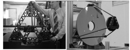
(b) 主镜的光学支撑结构及组装好的光学结构
