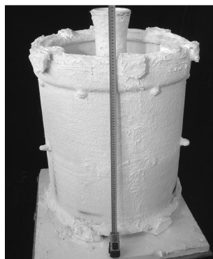
图3 制备的筒体型壳及底注浇道
