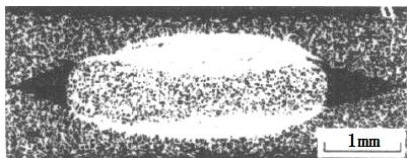
图 7 SiC/2024Al 电阻点焊时 SiC 颗粒的偏析
