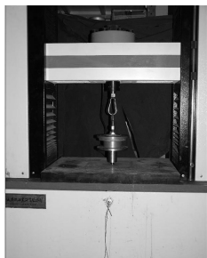
图7 活塞杆装配力和分离力试验图
