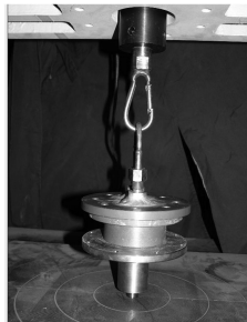
图7 活塞杆装配力和分离力试验图
