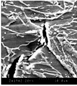
图1 微裂纹的翼型扩展<sup>[9]</sup>
