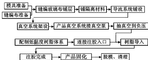
图3 平板试验件 VARTM 成型工艺流程图
