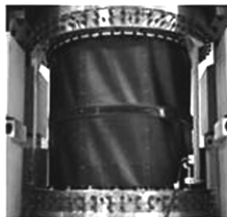
图 12 扭转载荷作用时格栅圆筒的屈曲模式
