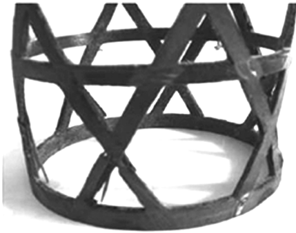
图7 格栅圆筒破坏模式
