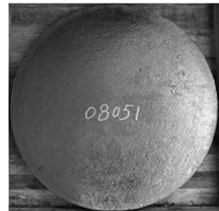
图5 经塑性变形后Φ850mm×75mm大尺寸复合材料锻件
