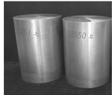
图4 采用粉末冶金技术制备的150kg复合材料坯锭
