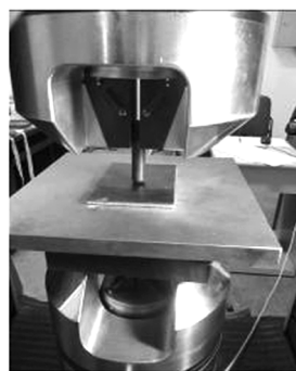
图 1 准静态压痕实验
