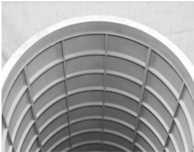
图 6 \Phi 418 mm \times 618 mm 粉末 TC11 整体大尺寸带内部网格加强筋薄壁近净成形舱体
