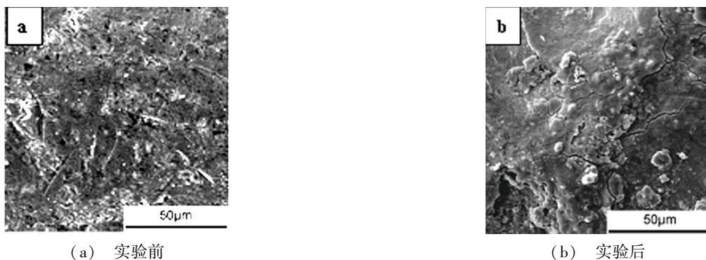
图1 湿热试验前后的金属引脚表面微观形貌
