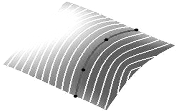
图4 由基准路径生成等距路径
