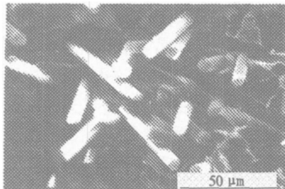
图 2 石英/GW-300-20复合材料 SEM 照片
