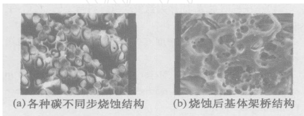
图 6 基体碳烧蚀后微观结构 540 ×
