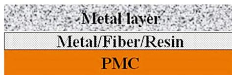
图4 金属-树脂基复合材料无胶黏剂连接的复合结构<sup>[33]</sup>
