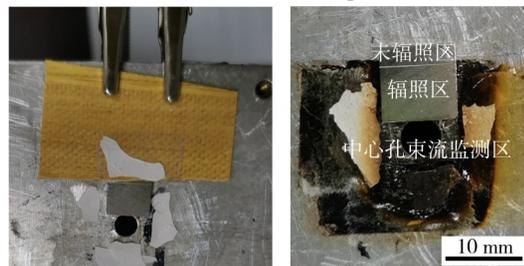
(a) 辐照前试样装载 (b) 辐照后试样表面
