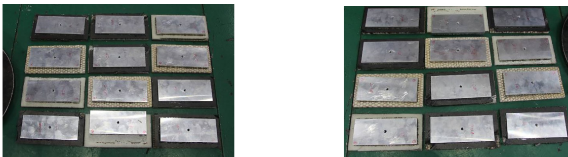
图6 三种双向加载工况的破坏试验件
