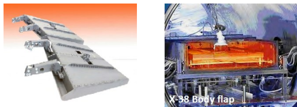
图 17 X-38 C/SiC 材料体襟翼构件及地面热考核试验
