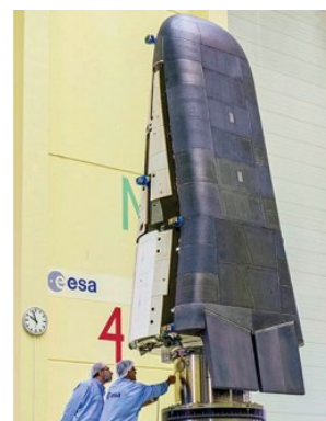
图9 组装完毕的欧洲 IXV 飞行器陶瓷盖板式热防护系统
