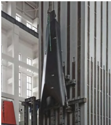
图9 着陆缓冲机构样机 [4]
