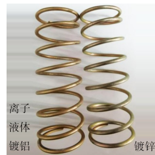
图12 两种镀覆工艺弹簧综合试验后对比
