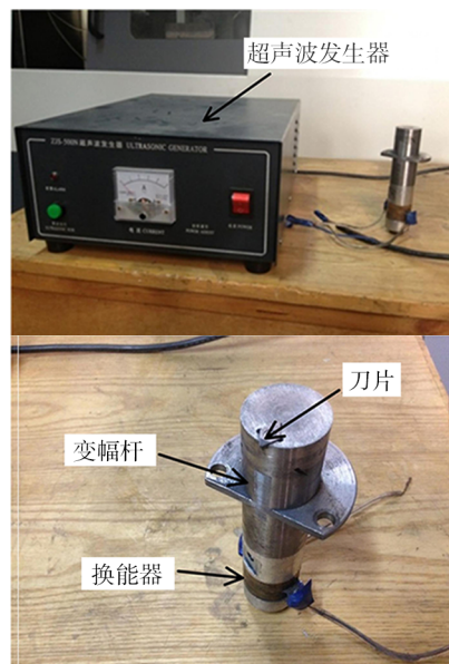
图2 二维纵-弯超声振动装置
