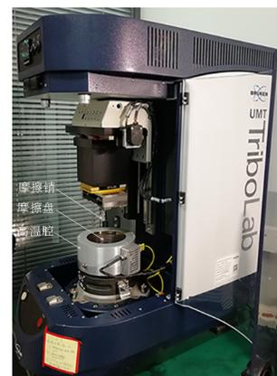
图2 摩擦试验设置
