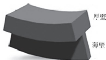
图3 壁厚不均零件的变形情况
