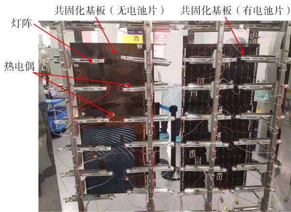
图7 共固化基板热真空试验
