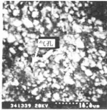
图3 PB30 复合材料表面 SEM 形貌 3 000 ×
