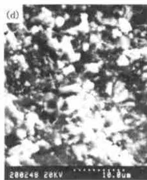
(d) PB30 复合材料液氮下脆断断口
