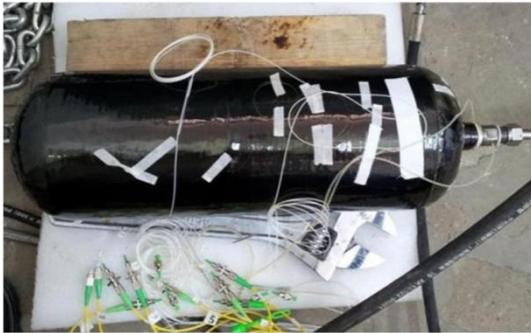
图7 复合材料气瓶水压疲劳试验照片
