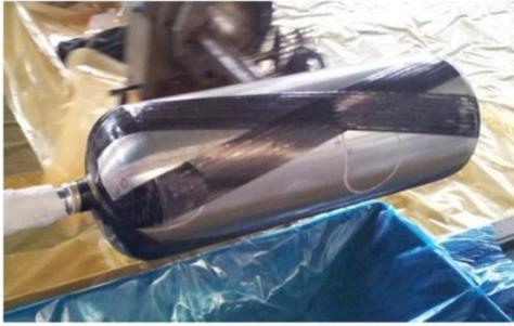
图4 复合材料气瓶缠绕过程
