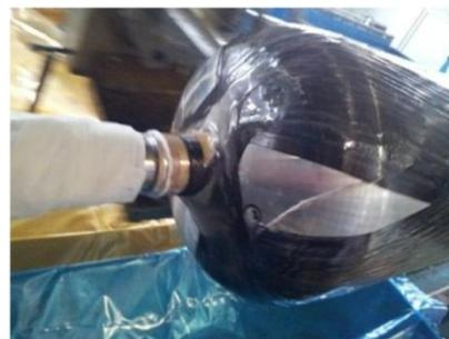
图6 复合材料气瓶缠绕过程中收缩段局部照片
