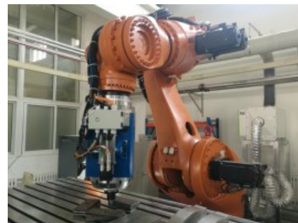
(b) 试验平台及曲面试验焊接工装实物
