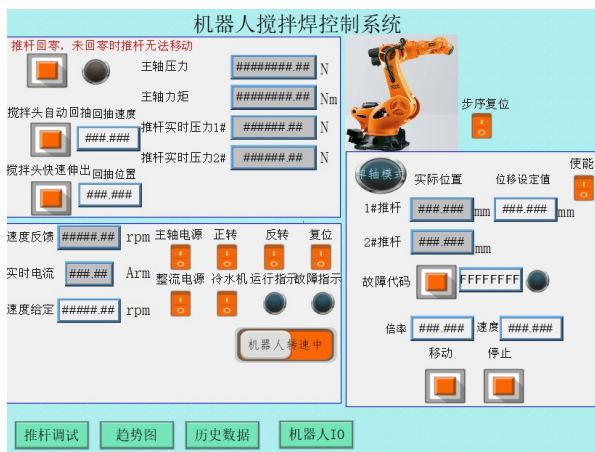
图8 机器人搅拌摩擦焊系统人机控制界面
