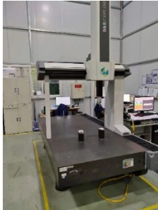
(d) 变形测量三坐标工作台
