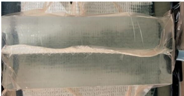
注:中间深色区域表明树脂优先通过三角区域浸润其周围纤维;图片右端为树脂注入端。
