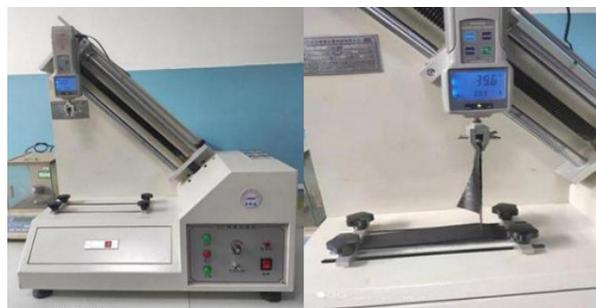
图1 预浸布带剥离试验设备与测试
