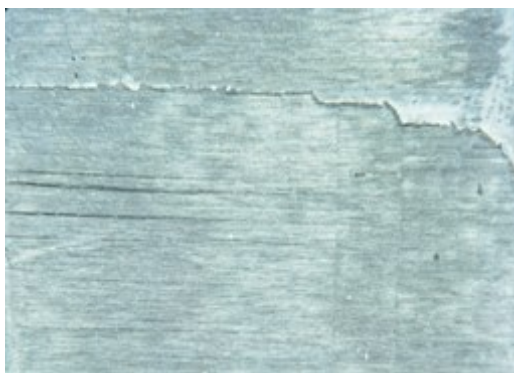
(a) 基材分层破坏
