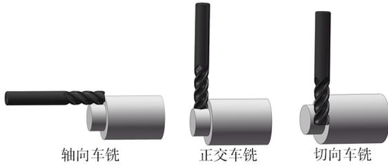
图1 车铣加工的主要加工方式
