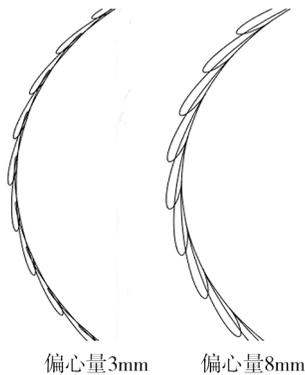
图6 偏心量对正交车铣外圆运动曲线的影响
