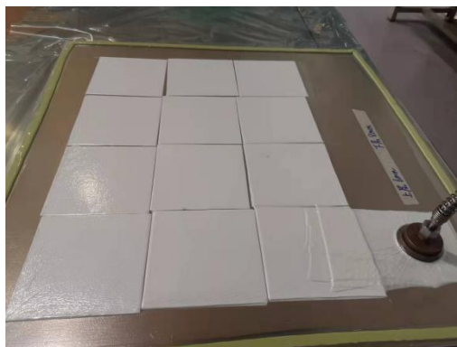
图1 泡沫压溃预处理示意图
