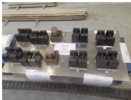
图 2 长期静压试验实物图
