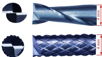
图2 传统端铣刀(上)和鱼鳞铣刀(下)结构示意图
