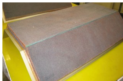
图11 美国好奇号火星车同位素热电发生器的热交换器绝热板
