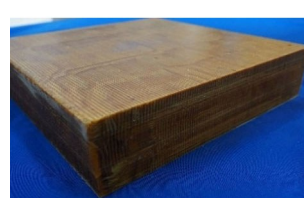
猎户座飞船和底部压缩垫 正交三向织物复合材料
