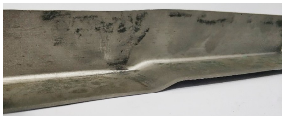
图10 TC2合金L截面型材下陷成形典型件
