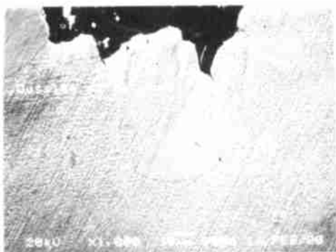
图5 Re层外侧凹凸不平 1 000 ×
