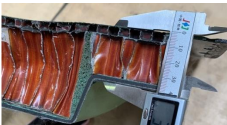
图2 V2500发动机声学衬垫解剖后的非连续蜂窝芯材
