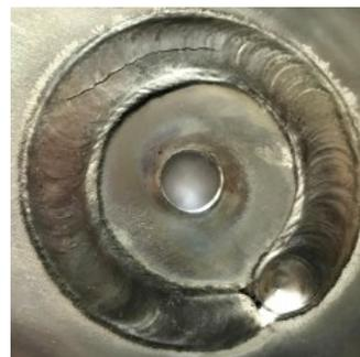
图1 自熔圆环试验
