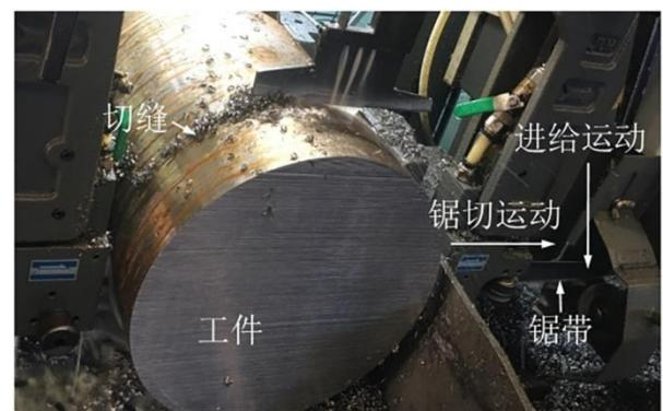
图1 锯切加工圆柱工件
