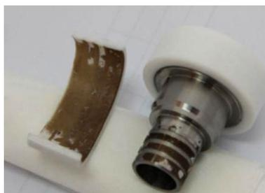
图4 开环形槽模拟件的粘接面形貌
